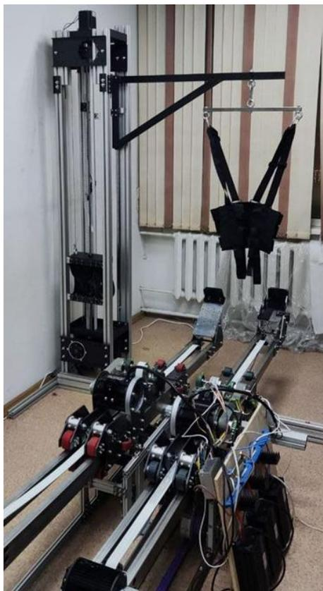
**Рисунок 1. Общий вид приводов конечностей и устройства вертикализации с корсетом-подвесом для пациента**
